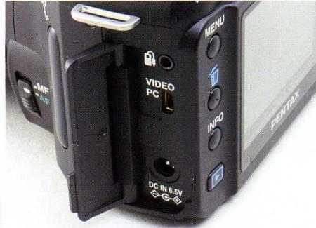
▲打開機身側蓋，線控孔、USB埠以及外接電源通通在這邊。
