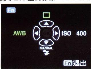
▲透過Fn加上十字方向按鈕，可調整白平衡、閃燈、ISO與單 / 拍設定。
