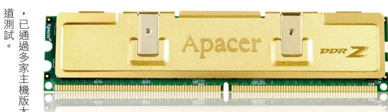
在環保節能的風潮下，DDR2 800記憶體模組也訴求低耗電設計，採用1.8伏特低工作電壓，超越前一代DDR所採用的2.5伏特電壓，大幅節省約50%的耗電量，並以先進的FBGA封裝技術，提供絕佳的散熱性與電氣特性。
