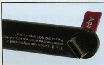
USB 接頭可旋轉 180 度，不論主機板或是筆電的角度方向通通適用。
